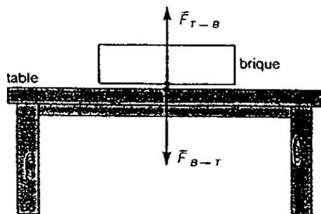
Fig. 18. Action et réaction de la brique sur la table.
