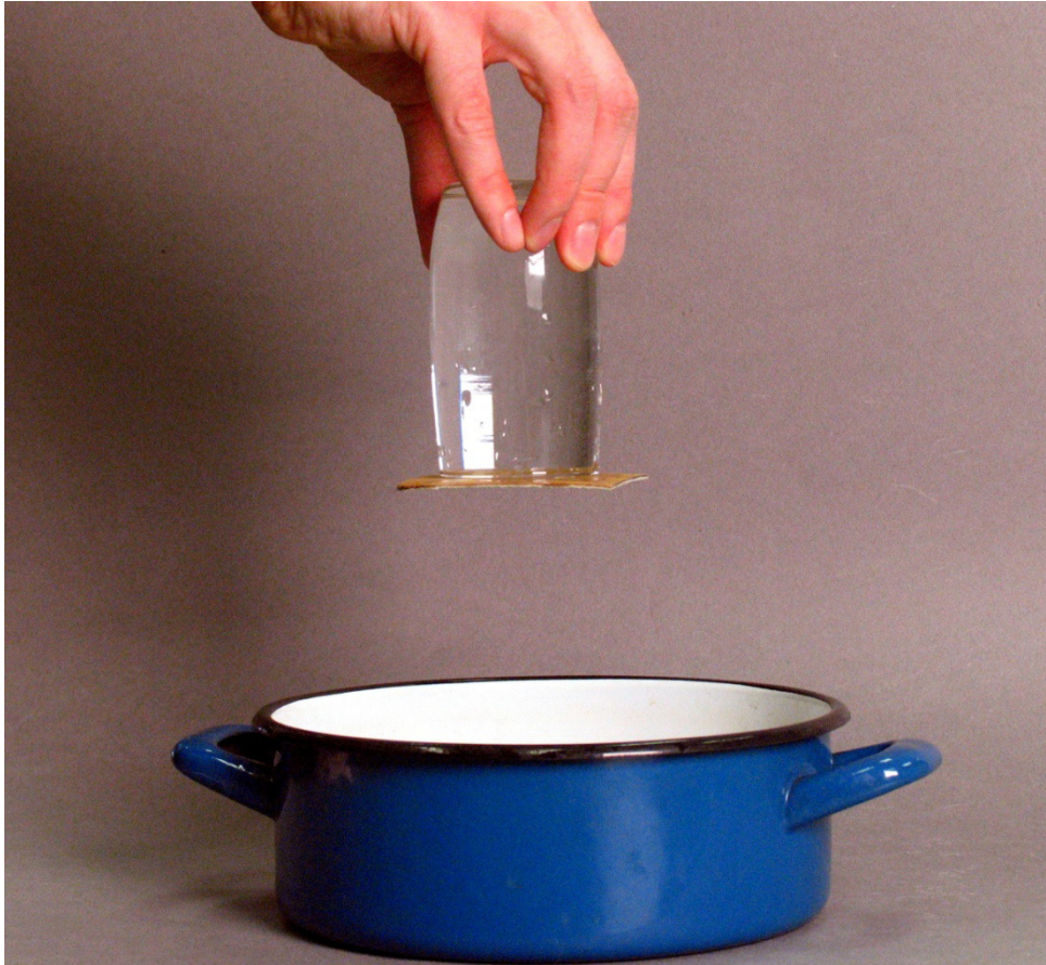
Verre plein d'eau recouvert d'un carton et retourné verticalement (crédit : Gorazd PLANINŠIČ)
