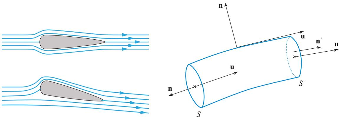
Figure 2. Gauche : réseau de lignes de courant dans l'écoulement plan autour d'une aile d'envergure infinie. Droite : tronçon d'un tube de courant, limité par deux sections  $S$  et  $S'$  traversées par le même débit, alors qu'aucun débit ne peut traverser la surface latérale, tangente en tout point au vecteur vitesse.
