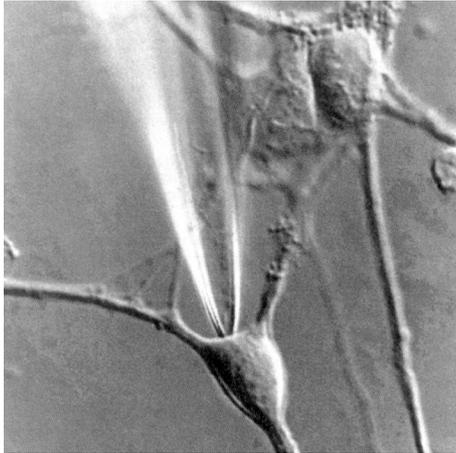
**Figure 10 - Microélectrode de patch-clamp (diamètre de pointe inférieur à  $1 \mu\text{m}$ ) au contact de la membrane d'une cellule nerveuse**
