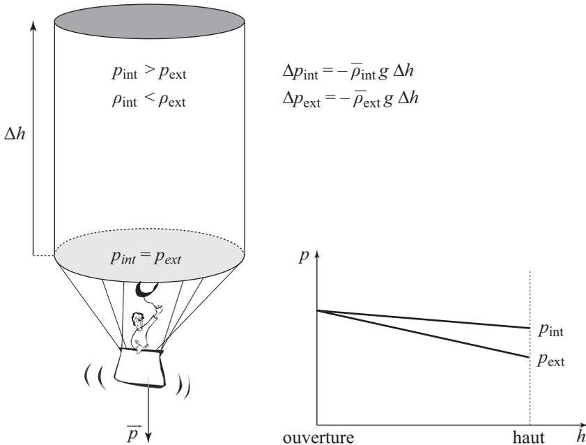
**Figure 6.1** - *Éléments pour comprendre la sustentation d'une montgolfière, ici représentée avec une forme cylindrique pour faciliter la compréhension de l'effet des forces de pression sur l'enveloppe (voir le texte et la note 73).*
