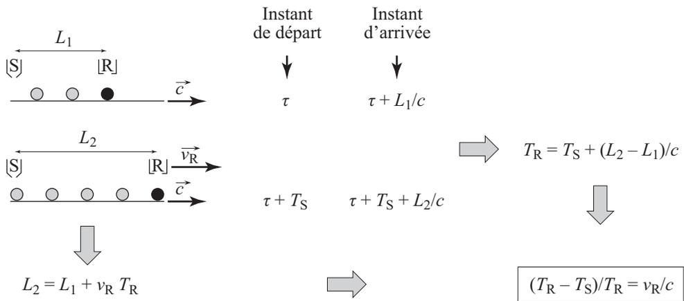
**Figure 5.4 - Exemple de modèle et de calcul élémentaires pour un cas d'effet DOPPLER**
